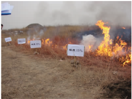
图2 不同浓度阻燃剂的阻燃效果 Fig.2 Effect of different flame retardant densities
