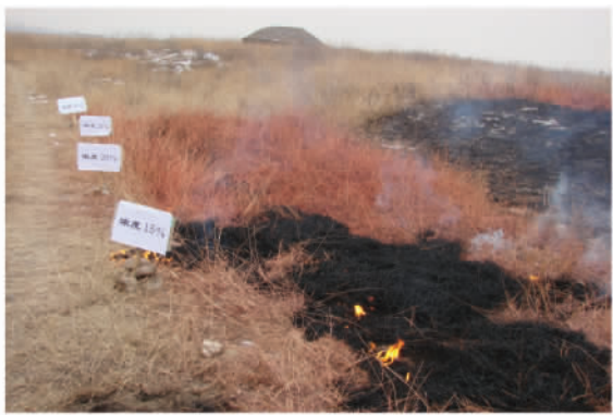
图3 不同浓度阻燃剂阻燃效果试验迹地 Fig.3 Experimental trace at different flame retardant densities
