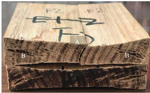
图2 呈现出严重的皱缩(A)和内裂(B)的100 °C试验径切板试件
